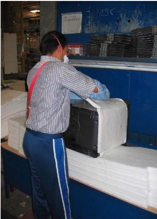
Foto 21. Coibentazione forno con materassino
