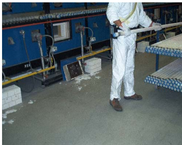
Foto 6. Sostituzione rulli (valore più elevato)
