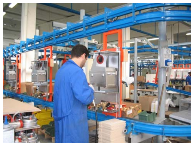
Foto 20. Fase di montaggio caldaie
