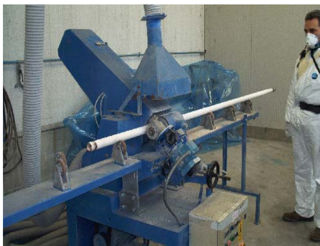
Foto 3. Pulizia del rullo mediante fresatura
