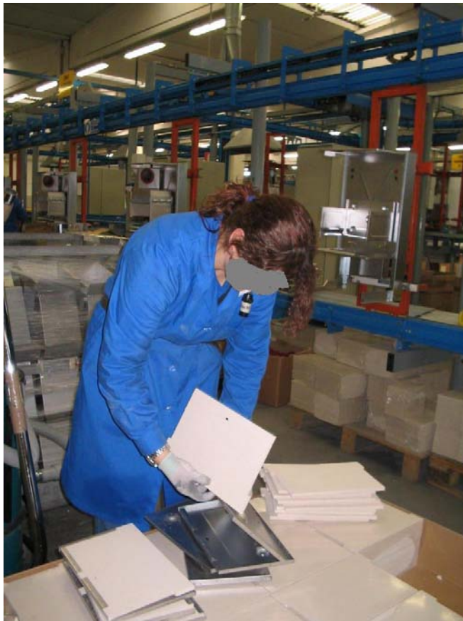
Foto 19. Inserimento dei pannelli nel telaio
